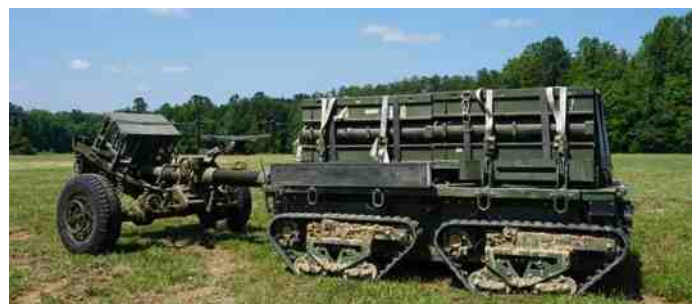
Een XR-P trekt een mortier. Foto: Stratom
