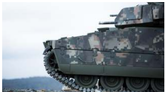
Om de gewichtstoename te compenseren heeft de DMO rubber band tracks besteld. Afbeelding: BAE Systems Hägglunds
